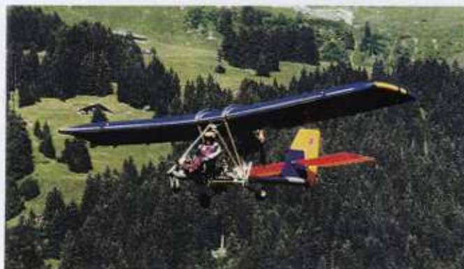
Der Pumpolino, bei dem auf der Grundstruktur eines UL-Rumpfes ein freitragender, pneumatischer Flügel mit einem asymmetrischen Profil installiert ist • Le Pumpolino, sur lequel se trouve installée, sur la structure de base d'un fuselage d'ultra-léger, une aile pneumatique en porte-à-faux au profil asymétrique.
