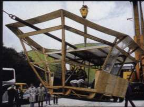
Erprobung des „Fluggefühls“ beim Start des geplanten Nurflüglers mit einem Kabinen-Mock-up. Das pneumatische Katapult (rechts) wurde schon getestet.
