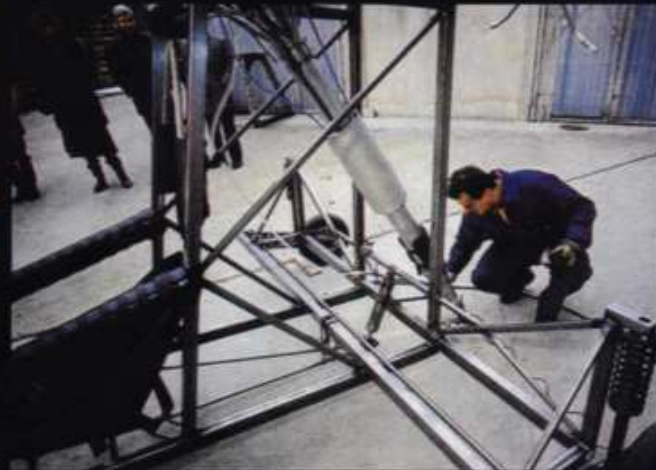
Erprobung des „Fluggefühls“ beim Start des geplanten Nurflüglers mit einem Kabinen-Mock-up. Das pneumatische Katapult (rechts) wurde schon getestet.
